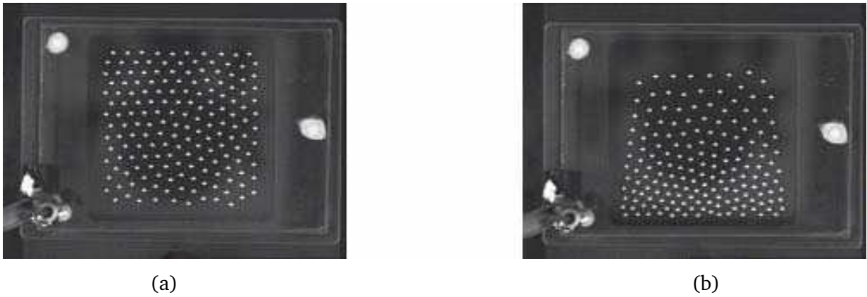
Figura 3. Efectos debidos a la gravedad y a la fuerza repulsiva de Coulomb: (a) configuración de esferas sobre un plano horizontal; (b) configuración distorsionada debido a la inclinación del plano del arreglo.
